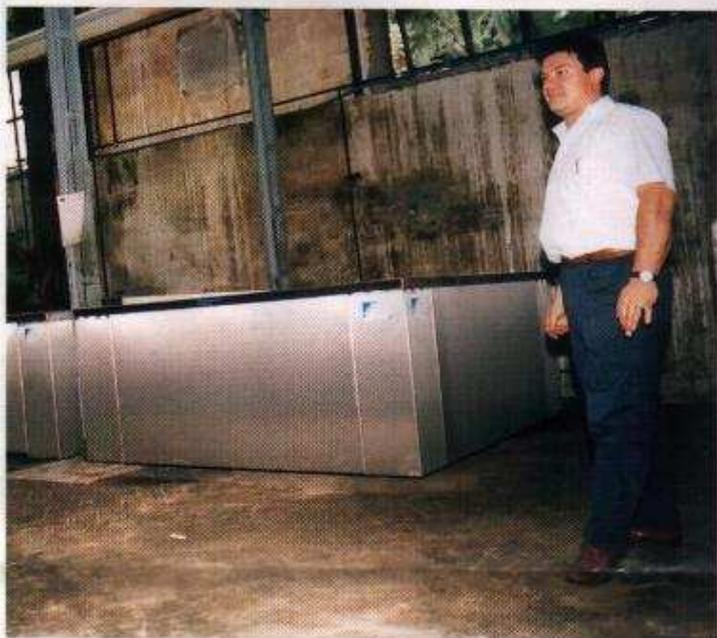
Impianto di lavaggio e manutenzione stampi composto da vasca di lavaggio caldo a ultrasuoni con detergente, vasca di risciacquo freddo con acqua e aria compressa, vasca di protezione e asciugatura finale. Dimensioni utili interne 1600 x 1600 x 900 mm
